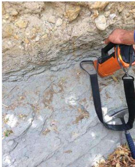
Exploración de uranio con uso de gamaespectrómetro.
