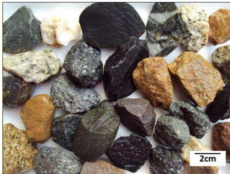
Muestra de aluvión del río Magdalena triturada en el laboratorio del SGC, retenida en tamiz  $\frac{3}{4}$ ", con potencial para producción de agregados, en la zona piloto de Bogotá.
