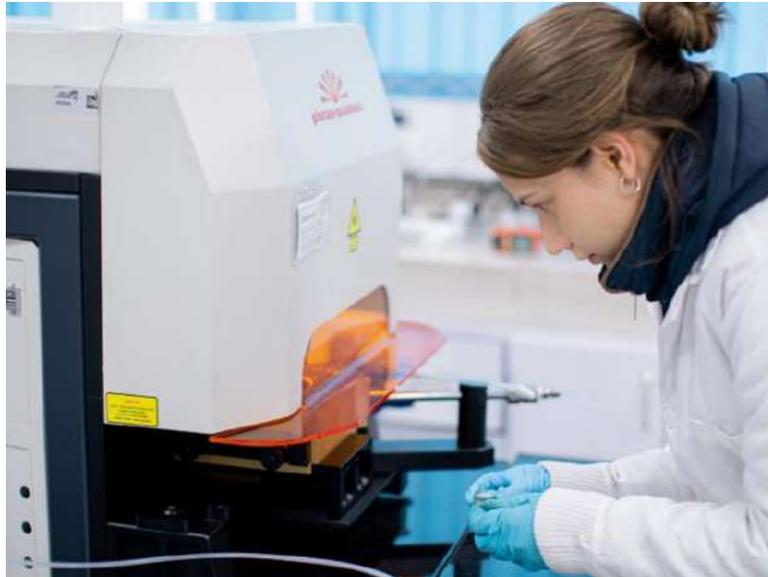
Figura. Montaje de probeta en la cámara del LASER para proceder con su datación mediante el método U–Pb en circón.
