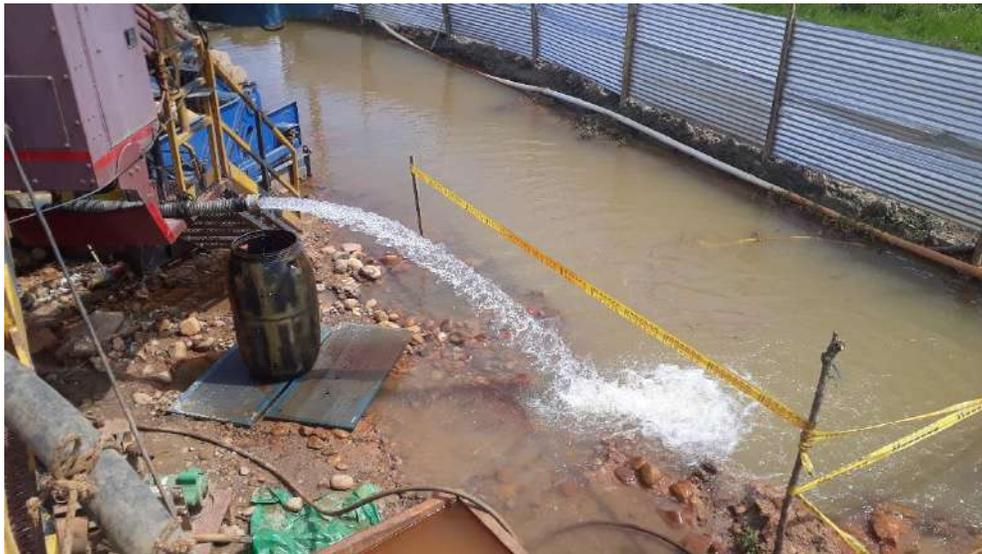
Figura Prueba de bombeo en el Pozo SGC YOPAL 3 Tilodiran, Caudal: 18 lps, Conductividad: 143 uS/cms.
